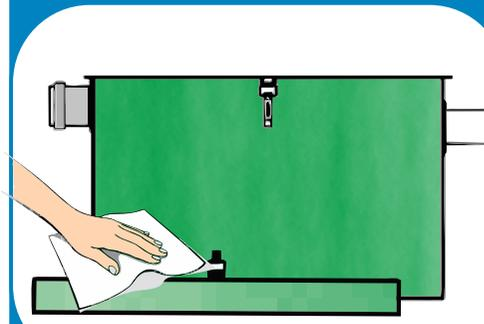
Убедиться в целостности патрубков, внутренних перегородок и уплотнителя крышки жироуловителя\*. Включить подачу воды до полного заполнения жироуловителя до рабочего уровня
