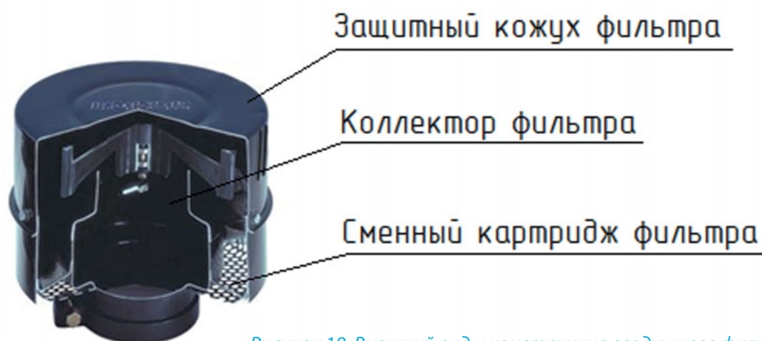
Рисунок 18. Внешний вид и конструкция воздушного фильтра
