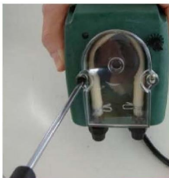
Рисунок 54. Порядок действий при замене перистальтического шланга в насосе-дозаторе Etatron B3-V PER 1–3 90/260V SANT
