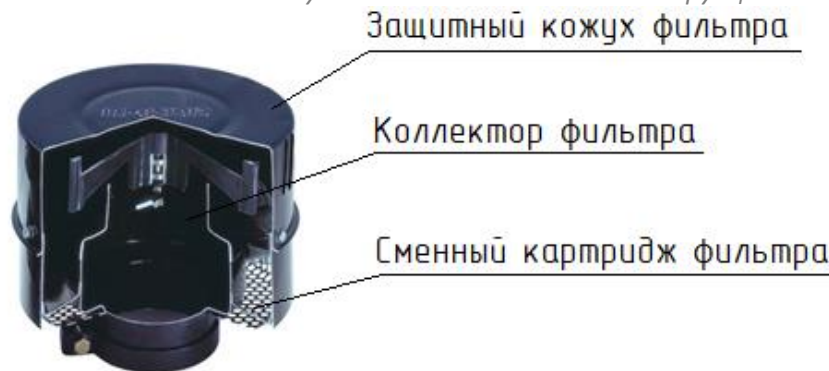
Рисунок 37. Внешний вид и конструкция воздушного фильтра.
