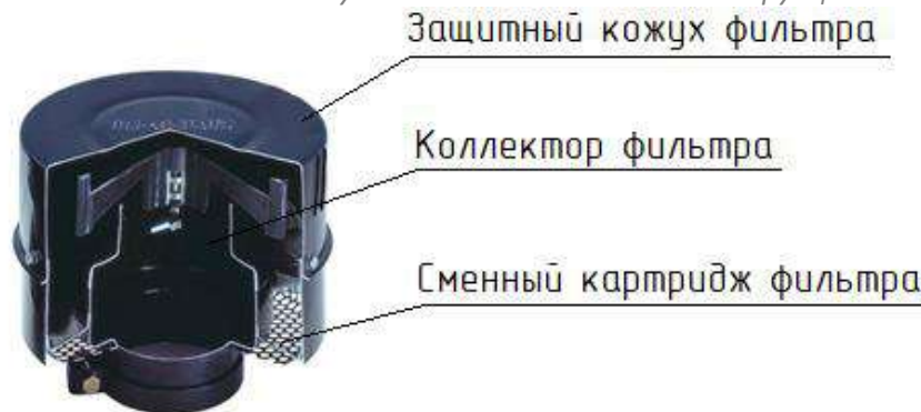
Рисунок 37. Внешний вид и конструкция воздушного фильтра.
