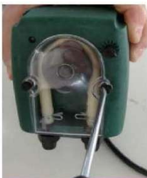
Рисунок 54. Порядок действий при замене перистальтического шланга в насосе-дозаторе Etatron B3-V PER 1–3 90/260V SANT
